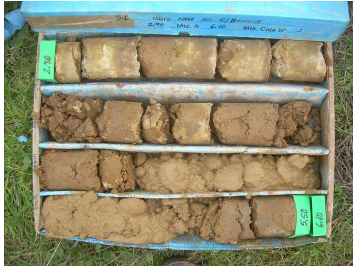
Fotografía 5. Gravas areno-limosas (UG-1). Sondeo S-1 de 2,90 6,10, caja 2.
