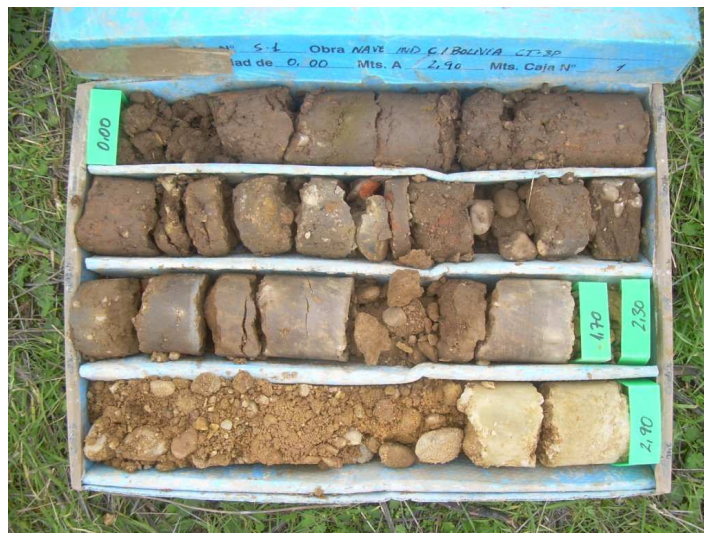
Fotografía 4. Rellenos antrópicos. Sondeo S-1, caja 1 de 0,30 a 1,70 m.
